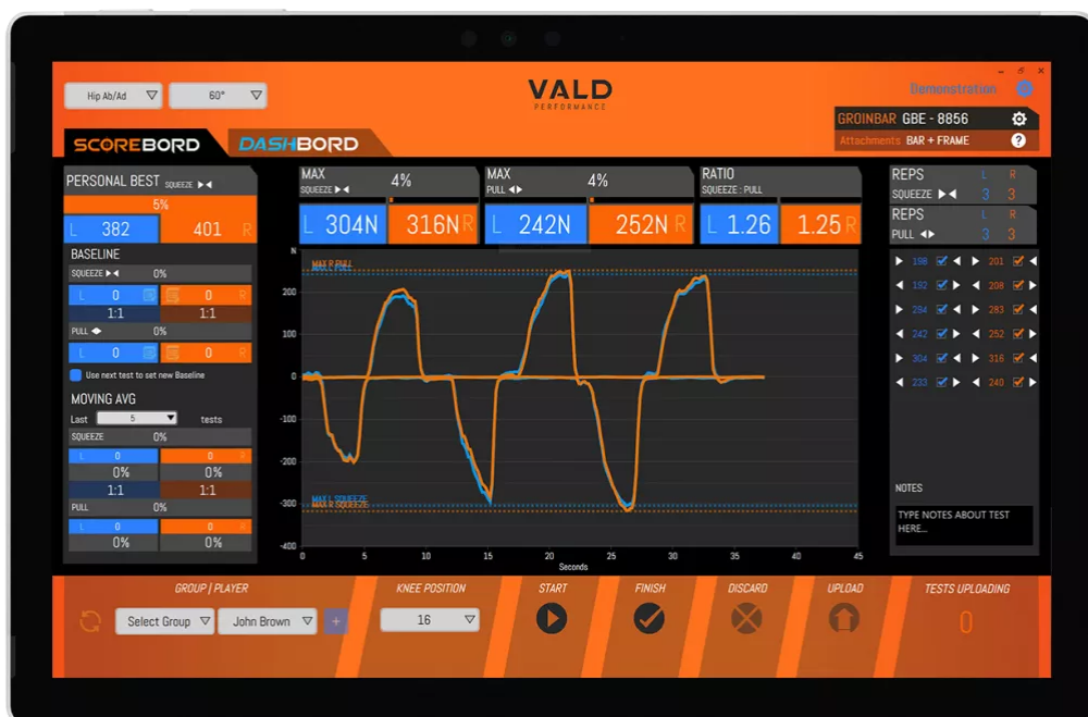
Figure 11 : Exemple de l'application IOS ScoreBord de Vald Performance permettant d'enregistrer les données d'évaluation du GroinBar en temps réel.
