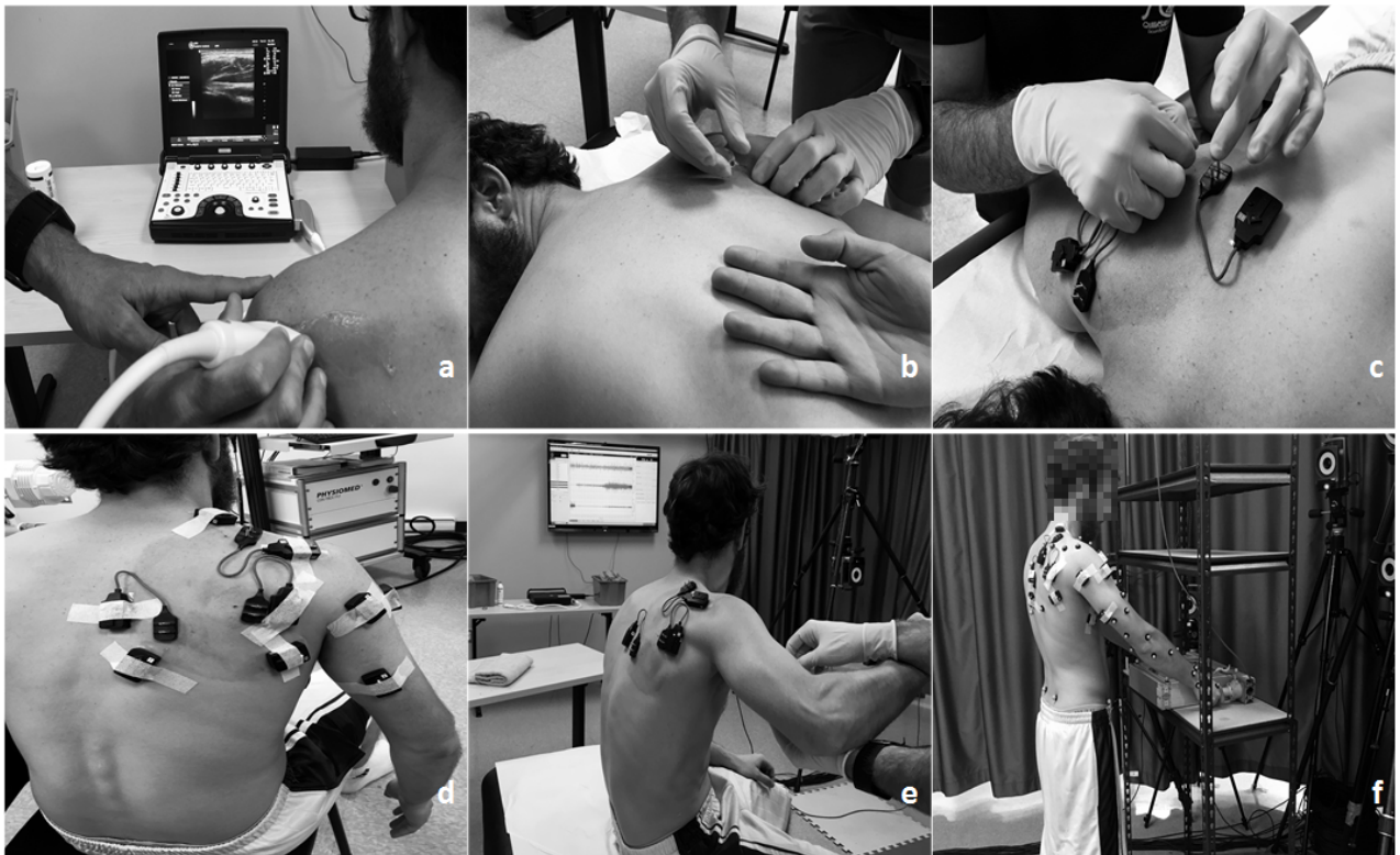
FIGURE 2.3.3 – Procédure expérimentale : examen échographique (a), insertion des électrodes EMG intramusculaires (b), pose des capteurs EMG intramusculaires (c), pose des capteurs EMG de surface (d), tests MVC (e) et lever de caisse (f).
